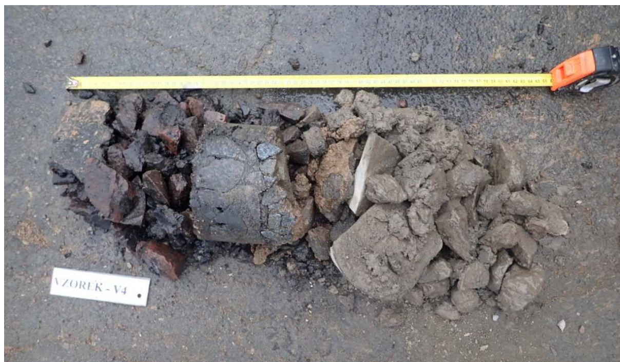
Obr. 3 - Jádro vývrtu Vzorek – V4 (in situ).
