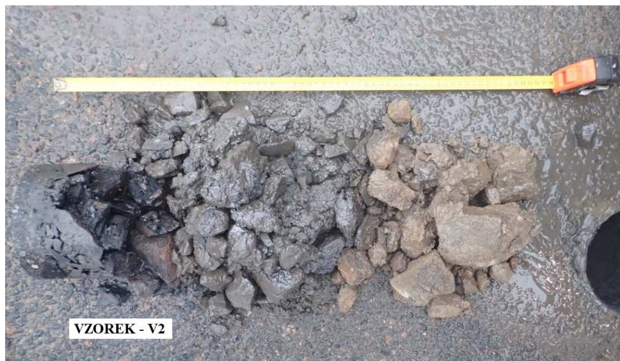
Obr. 1 - Jádro vřvtu Vzorek – V2 (in situ).
