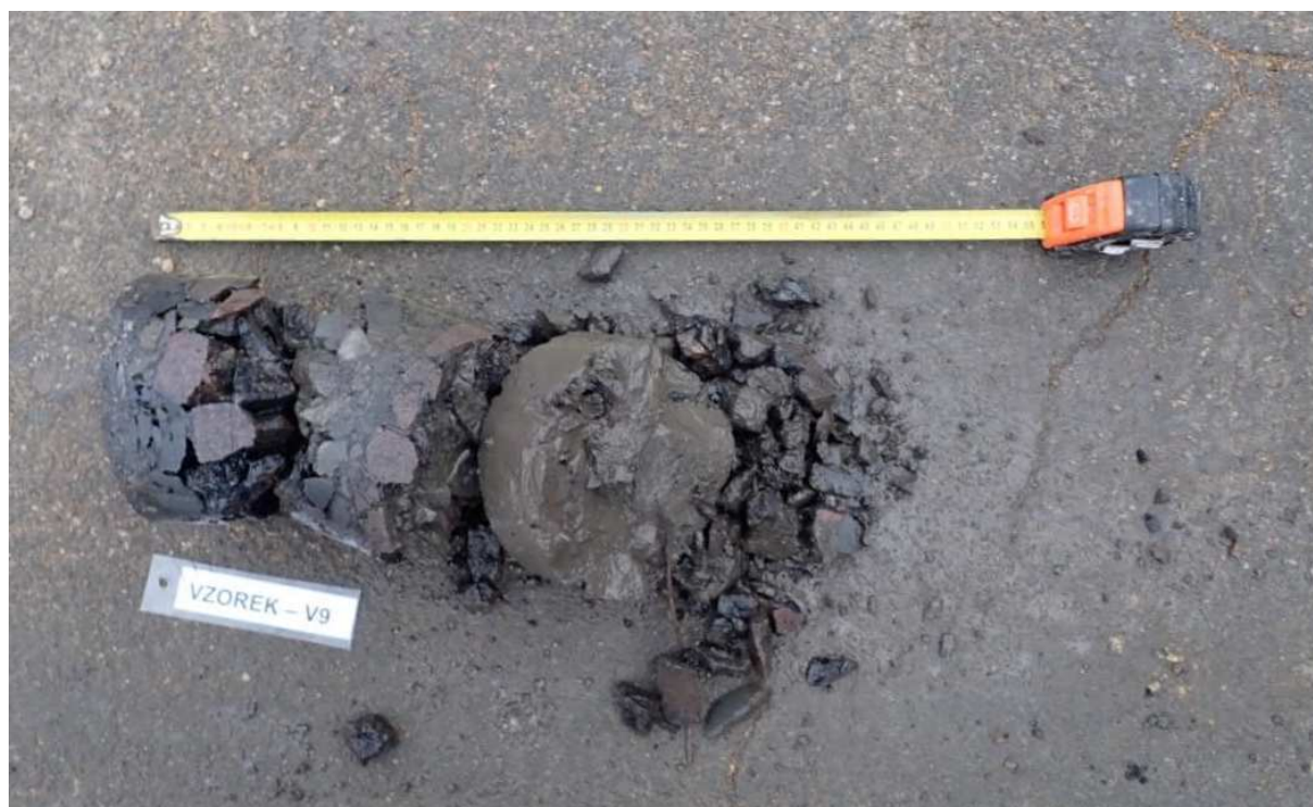
Obr. 7 - Jádro vývrtu Vzorek – V9 (in situ).
